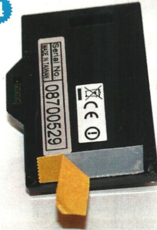
Schritt 4: Auf der Rückseite des HF-Modul-Gehäuses einen schmalen Streifen doppelseitiges Klebeband anbringen.
