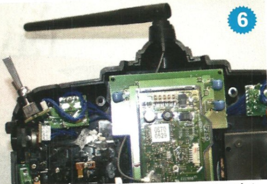
Schritt 6: Nun noch den zugekauften Antennenführungsring aufsetzen, die ebenfalls neue 2,4-GHz-Antenne einsetzen und am HF-Modul anstecken.
