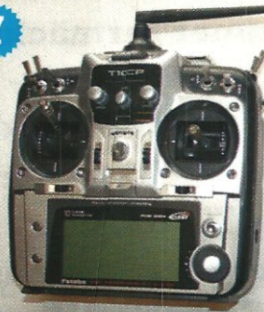
Schritt 7: Gehäuserückwand aufsetzen und verschrauben, Akku einsetzen – fertig ist der Umbau. Die Antenne befindet sich nun dort, wo sie hingehört und der „Erdspieß“ hat ausgedient.
