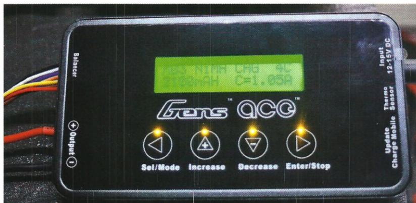
Das zweizeilige Display zeigt die wichtigsten Daten. Bedient wird der Lader über vier Tasten, die man nicht drücken, sondern nur leicht berühren muss.
