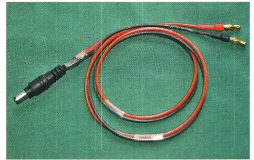
Das Speisekabel wurde auf 4-mm-Goldkontaktstecker umgerüstet und kann jetzt entweder an ein Netzteil oder an geeignete Polklemmen angesteckt werden.
