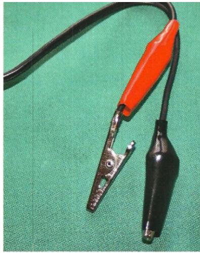
Die Krokodilklemmen des Speisekabels sind nicht wirklich für den Anschluss an die Pole einer Autobatterie geeignet.
